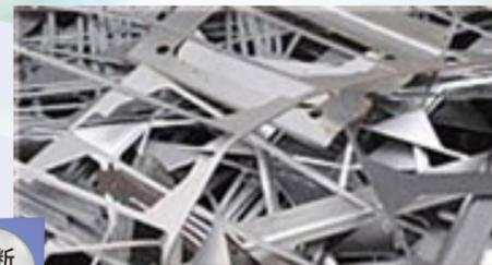
打ち抜きの薄物鉄板
